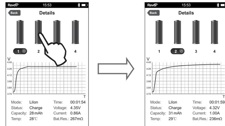
4. Drücken der Schachtnummertaste stoppt den Programmetrieb in dem Schacht.
