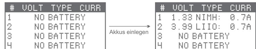
4. Drücken Sie die rot-grün blinkende Schachtnummerntaste. Der entsprechende *CURR* Wert auf der Anzeige blinkt, um zu signalisieren, dass der Ladestrom nun nach Belieben innerhalb von 7-10 Sekunden geändert werden kann. Drücken Sie <▲> und <▼>, um die Höhe des Ladestroms zu ändern, und anschließend <ENTER>, um den Ladevorgang in allen bereiten Schächten zu starten.
