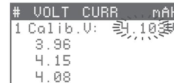
1. Haben Sie einen Viersatz Akkus mit stabiler Offlinespannung zur Hand, vorzugsweise allesamt über 4.0V. Messen Sie mit Hilfe Ihres digitalen Multimeters die vier Akkuspannungen präzise in der "1V"-DMM-Einstellung auf eine Auflösung von 3+ Kommastellen hin, z.B. "4.10285V, 3.97013V, usw".
